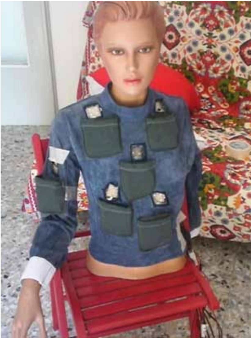
Figura 1: fotografia del manichino. Presenta 6 cuscinetti sotto i quali ci sono 6 pulsanti; sopra ogni pulsante è presente un led che si accende casualmente o manualmente in base all'impostazione dell'hardware di controllo
