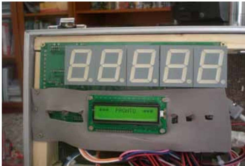
Figura 4: piastra con pulsantiera monitor e led crono
